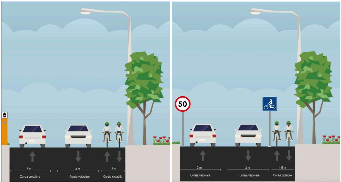
Fig. 30 - Rappresentazione del tracciato di progetto ed esempi di sezioni stradali.
